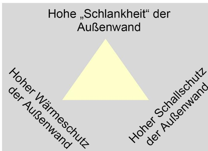
Abb. 4: Spannungsfeld „Energieeffizienz“ zu einer Außenwand (IFB 2007)
