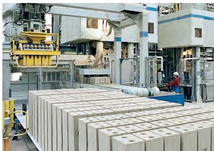
Kein Abfall: Reststoffe aus der Mischung kehren zerkleinert in den Produktionsprozess zurück.
