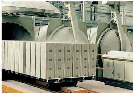
Der Dampf-Härtungsprozess bei der Herstellung ist kurz und verbraucht wenig Energie, weil der Dampf mehrfach verwendet werden kann.
