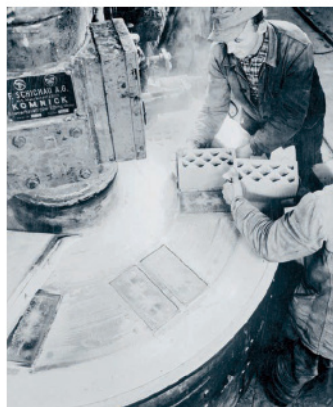
Produktion von Lochsteinen an einer Drehtischpresse, 1950. FOTO: BV KALKSANDSTEININDUSTRIE
