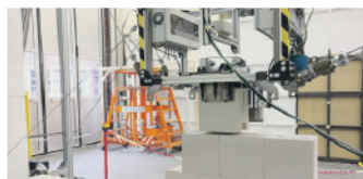
Eines von vielen spannenden Forschungsprojekten der Kalksandsteinindustrie ist die Erprobung der Seilrobotertechnologie. FOTO: UNIVERSITÄT DUISBURG-ESSEN/PATRICK LEMMEN
